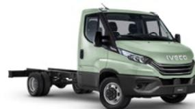
Il cabinato con ruote gemellate è disponibile con una lunghezza carrozzabile fino a 6.750 mm, una massa totale a terra fino a 7,2 tonnellate e un carico utile fino a 5.000 kg. Si distingue per la robustezza e la versatilità senza pari.
